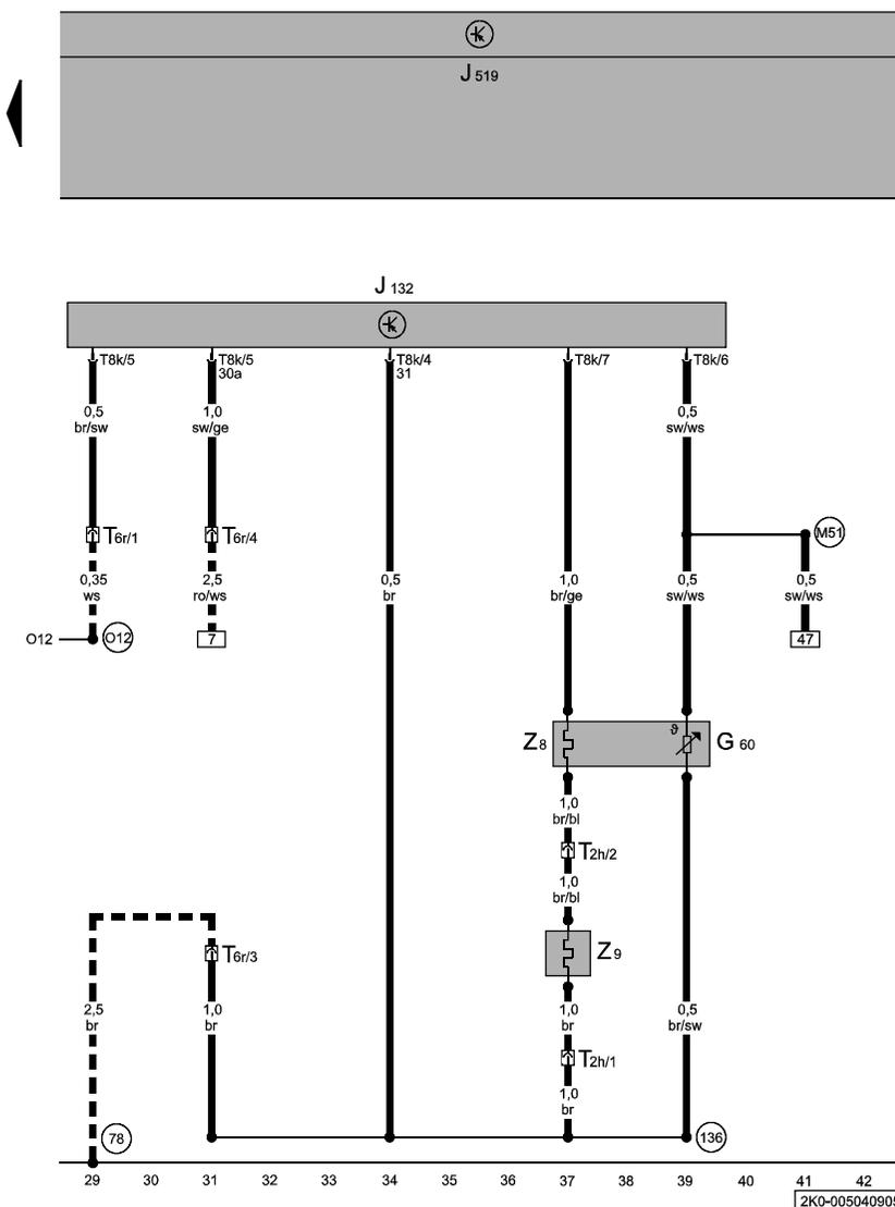
**Блок управления обогрева сиденья переднего пассажира, датчик температуры сиденья переднего пассажира, нагревательный элемент подушки сиденья переднего пассажира, нагревательный элемент спинки сиденья переднего пассажира**
