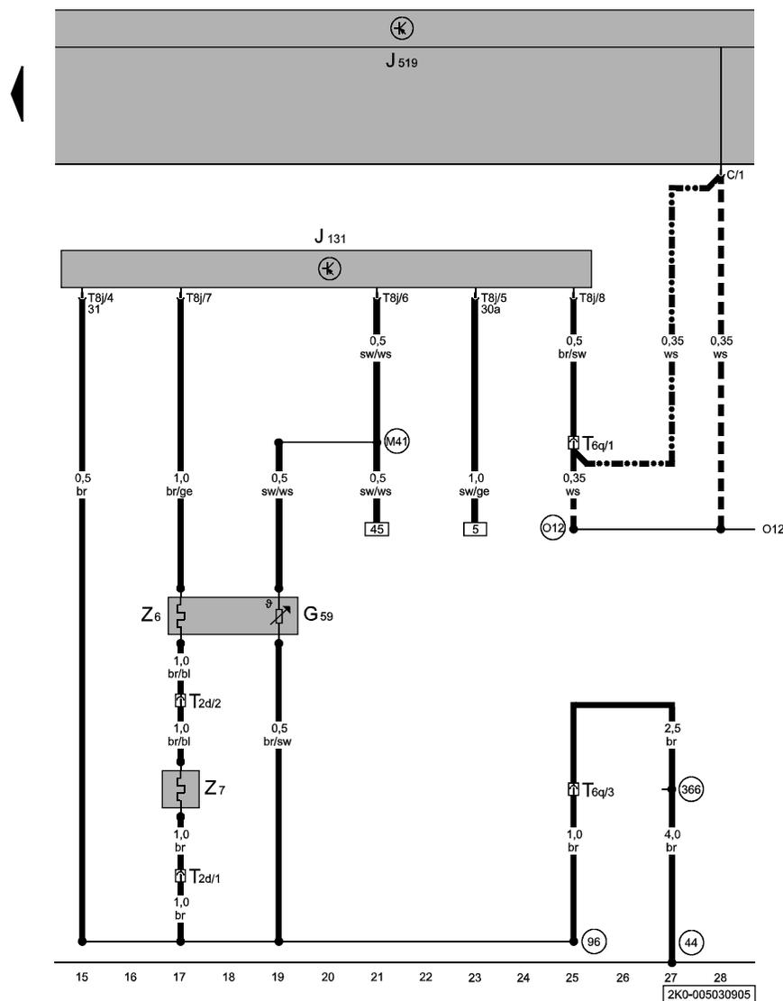
**Блок управления обогрева сиденья водителя, датчик температуры сиденья водителя, нагревательный элемент подушки сиденья водителя, нагревательный элемент спинки сиденья водителя**
